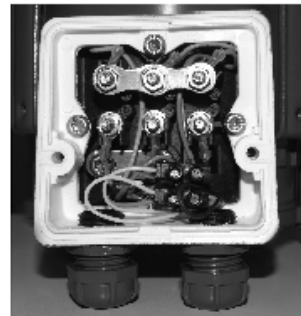
TK = Protector térmico Fusión térmica Thermal overload protector
